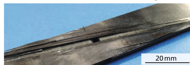
1 Steifigkeitsänderung einer multidirektional verstärkten CFK-Probe unter zyklischer Zugbelastung und Probe nach Versagen.
